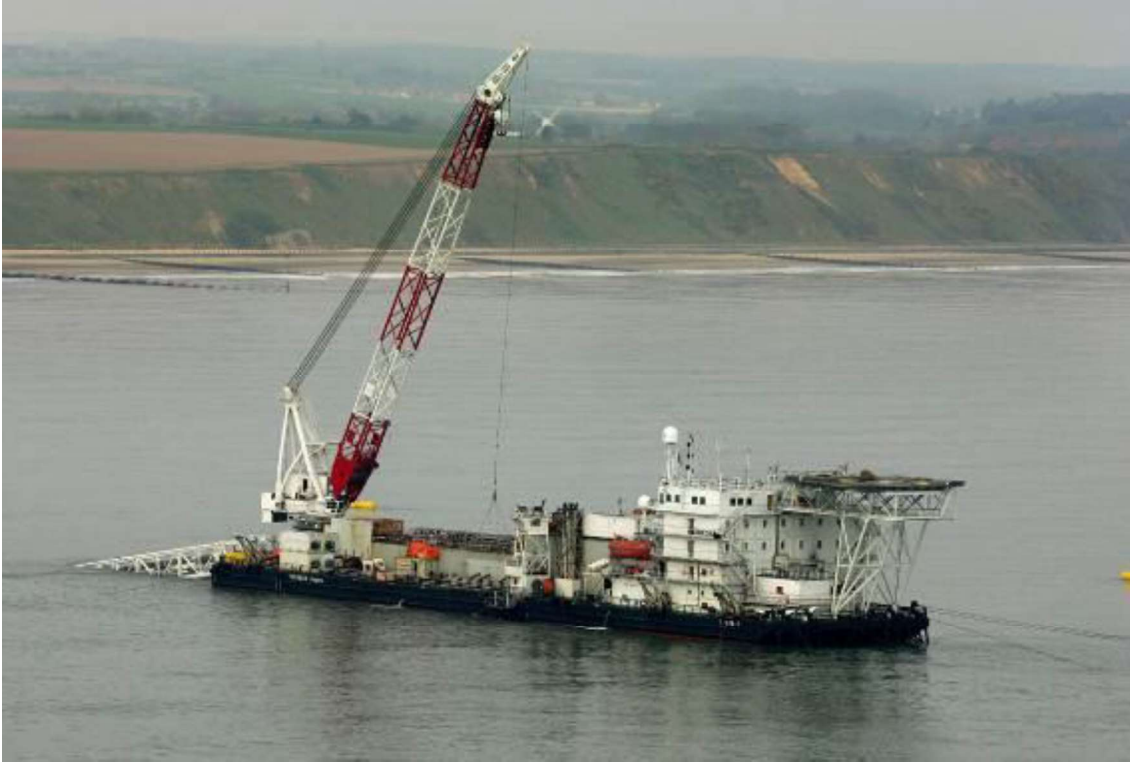
Şekil 14.4: S Tip Boru Döşeme Gemisi
