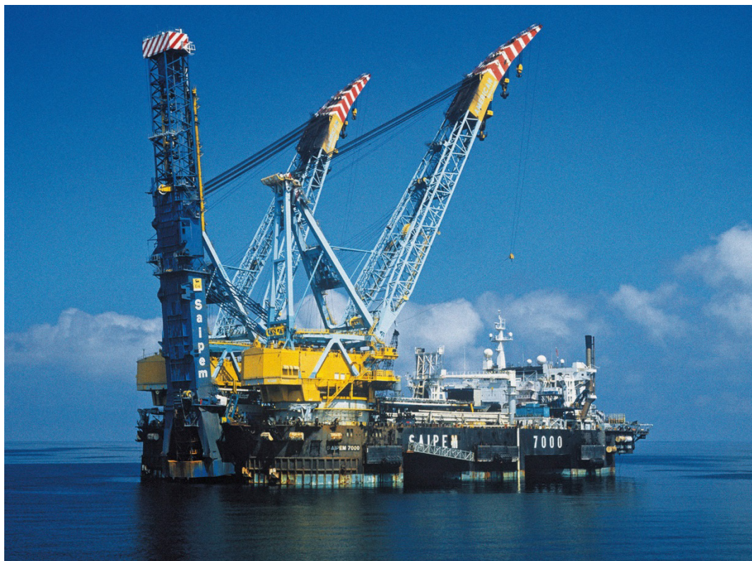
Рисунок 5.33 Типовое глубоководное средство для прокладки трубопроводов методом J-образной укладки труб
