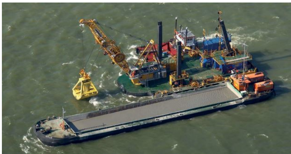
Рисунок 1.4-11 Пример грейферного землечерпательного снаряда - Kahmari 2 (Terramare Oy Boskalis Nordic Oy)
