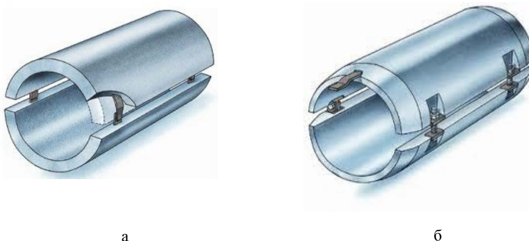
Рисунок 1.4-4 Типовой пример цилиндрического браслетного анода (а) для S-образной укладки труб с обетонированием и конического анода (б) для J-образной укладки труб без обетонирования
