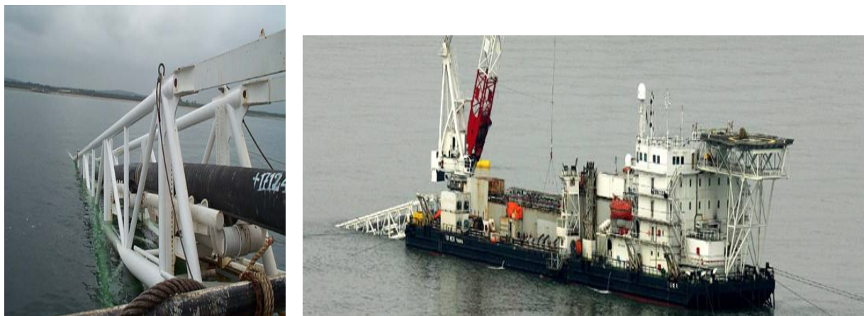
Рисунок 1.4-22 ТУБ «Tog Mor» (Allseas) для укладки на мелководье
