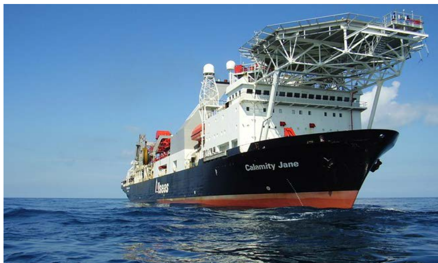
Рисунок 1.4-16 Судно обеспечения для срезки/выравнивания участков морского дна типа «Calamity Jane»
