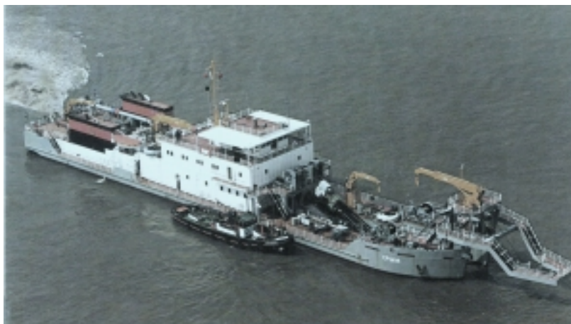
Рисунок 1.4-9 Российский землесосный снаряд с фрезерным рыхлителем - Диксон (МРТС)
