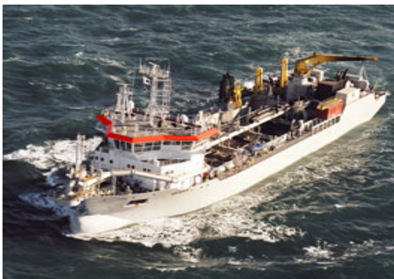
Рисунок 1.4-10 Самоотвозной земснаряд с волочащимся грунтоприёмником «Taccola»
