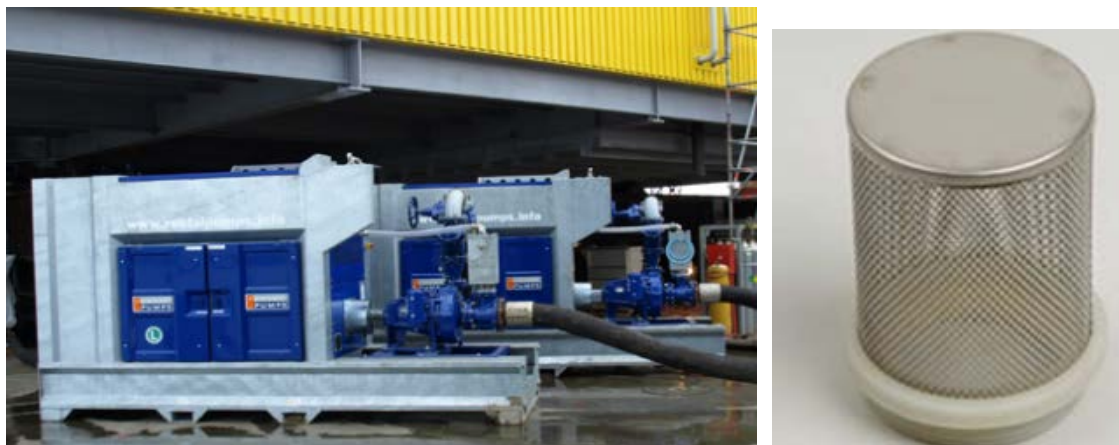
Рисунок 1.4-32 Насосное оборудование и защитные устройства для забора воды на гидроиспытания
